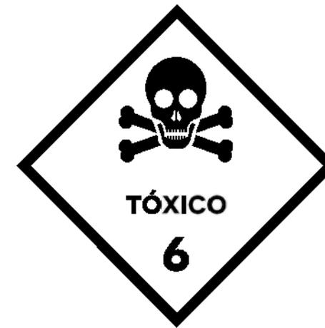
OS SIMBOLOS FORAM PROJETADOS CONFORME **NBR 7.500** E DEVEM SEGUIR AS VARIAÇÕES DE FORMATO PREVISTOS NAS PÁGINAS 62 E 73 DA NORMA. CONFORME A **NBR** O CONTORNO É O QUE GARANTE A LEGIBILIDADE EXIGIDA.
